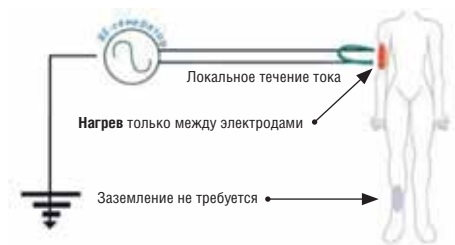
РИС. 3. Схема биполярного RF-аппарата
